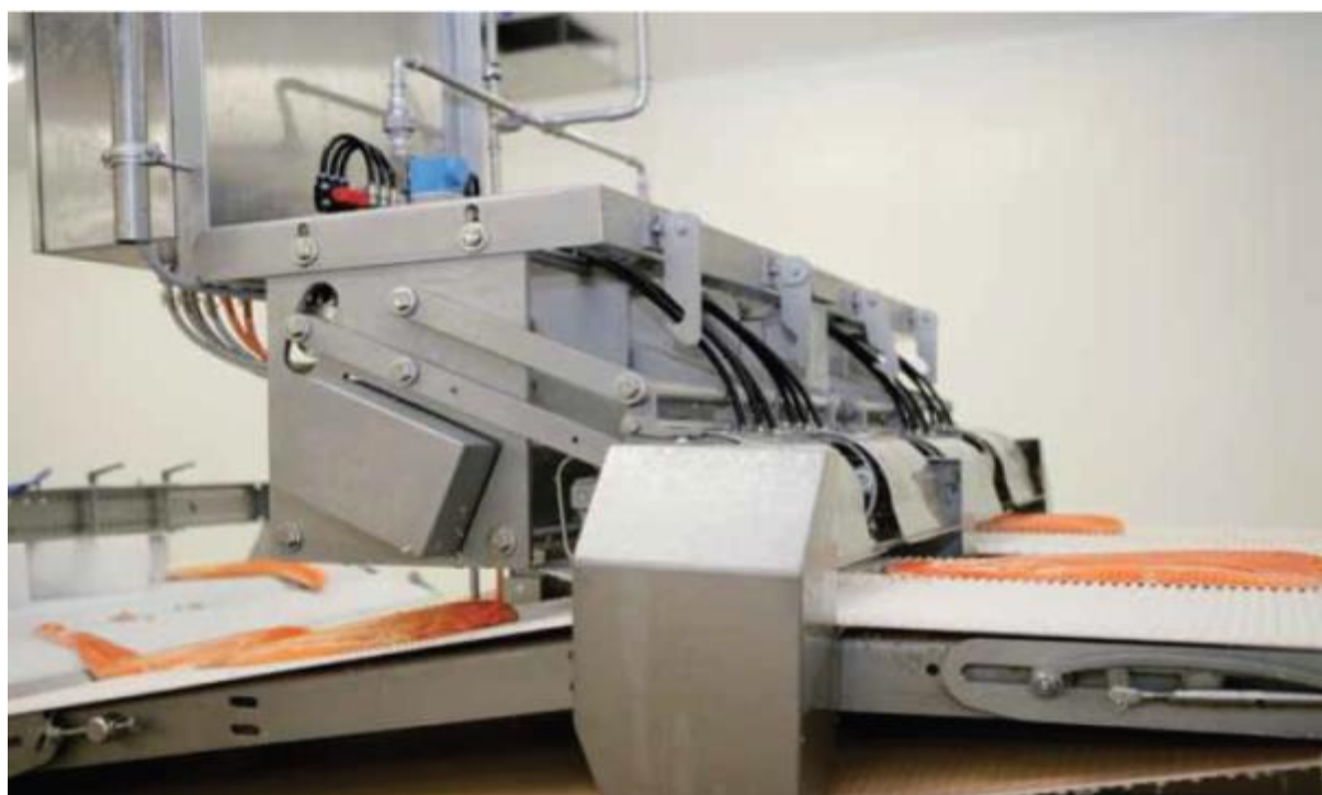
Figur 5. Pinnebeinfjerner fra Marel, for postrigor laksefilet.
