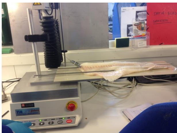
Figur 2. Trekkraftoppsett (til venstre) og målt trekkraft for fisk som er frosset i pre-rigor tilstand og tint opp igjen, for bein nr. 1 til nr. 15 (til høyre).
